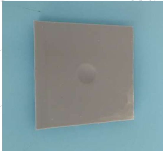
图 10-50%磷酸试验前照片
