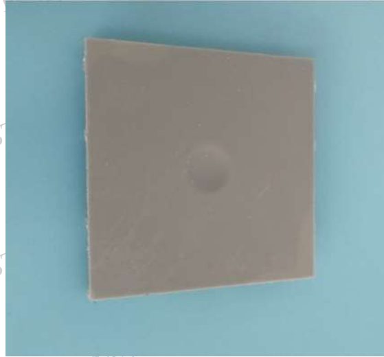
图 4-30%亚硫酸试验前照片 Photo 4-before 30% sulfite test
