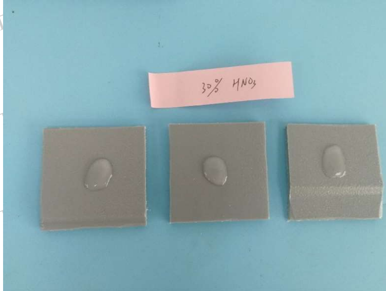
图 8-30%硝酸试验中照片 Photo 8-in 30% nitric acid test
